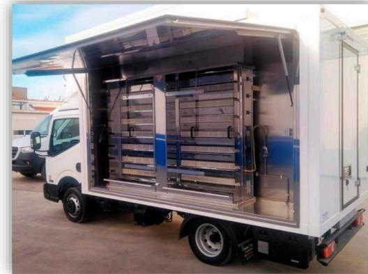
Estos vehículos suelen llevar incorporadas una cámara frigorífica independiente en la parte delantera homologada con ATP. Pueden llevar instalados 1 o 2 asadores de pollos con su instalación de gas homologada. También llevan incorporadas una mesa de trabajo en el interior con superficie de acero inoxidable con un lavabo encastrado y su correspondiente instalación de fontanería.
