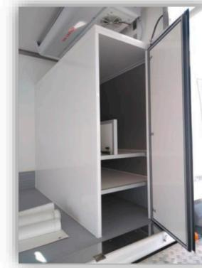
Carrocerías fabricadas en panel sándwich de poliéster de 45mm o de 60mm (isotermo). Llevan incorporadas un portón lateral completo abatible para dar la mayor sombra posible. También se pueden fabricar e instalar cajones bajo el chasis tanto de acero pintado como inoxidable totalmente a medida para guardar los elementos de montaje del puesto de venta.
